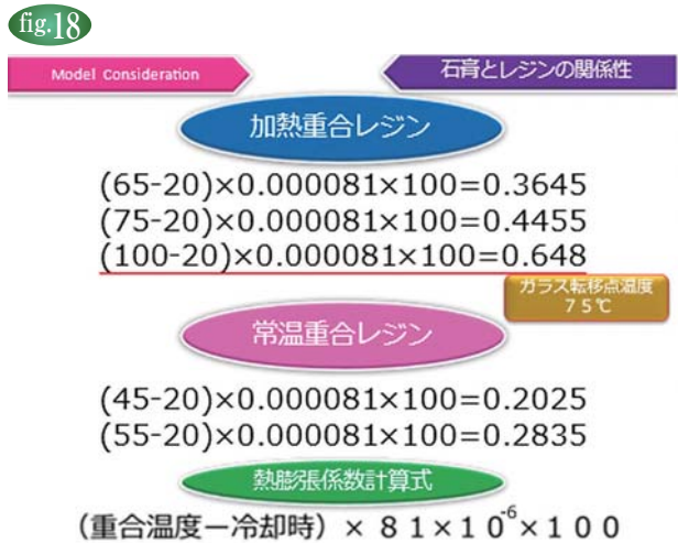
fig.18 重合温度によるレジンの収縮と熱膨張係数計算式
