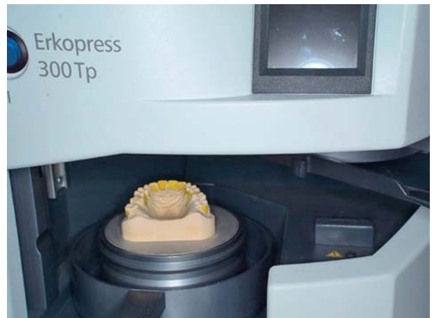
fig.9 シートの圧接 シートは指定の温度で圧接する。本症例に用いたシートは、155℃である。また、PET樹脂シートは吸湿しやすいため、保管に注意しなければならない。
